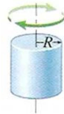
Este ejemplo es un problema de sustitución, con el uso de la definición de momento de inercia. Se debe reducir el integrando a una sola variable. Es conveniente dividir el cilindro en muchos cascarones cilíndricos, cada uno con radio  $r$ , grosor  $dr$  y longitud  $L$ , como se muestra en la figura. La densidad del cilindro es  $\rho$ .
