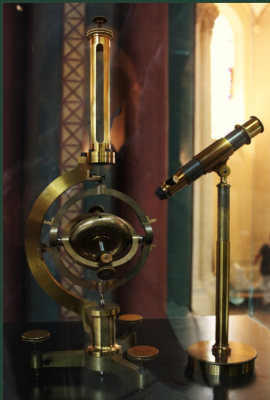
Giroscópio feito em 1852 por Léon Foucault.
