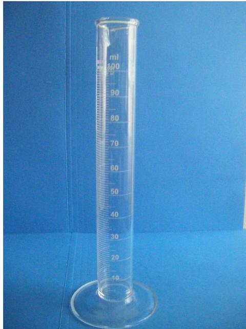
Figura 5: Probeta de 100ml
