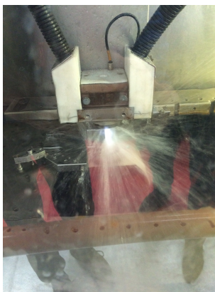
Figure 17: Electro-érosion, Usinage du porte bobine
